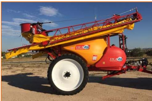
Barra hidráulica con asistencia de aire por lona
