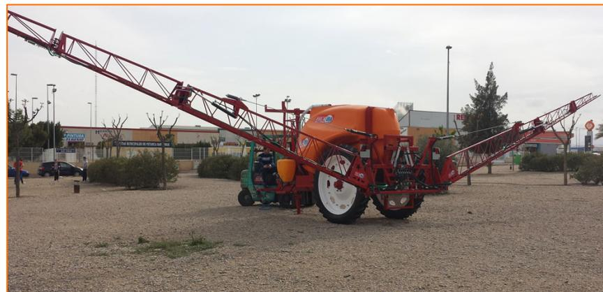
Diferentes modelos de barras y/o con pliegues y/o elevación y/o corrector de giro hidráulicos así como con geometría variable
