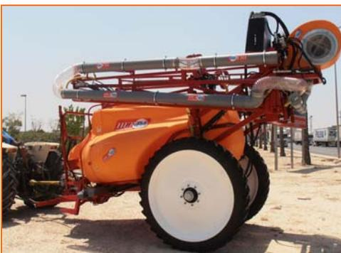
Barra hidráulica con asistencia de aire por tubería en PVC
