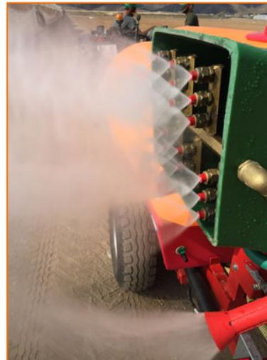
Los ventiladores centrífugos de HERPA® con salida concentrada y orientable permiten obtener los máximos caudales y alcances.
