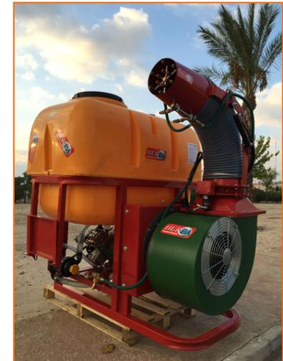
Atomizador suspendido con cañón con codo flexible de HERPA®
